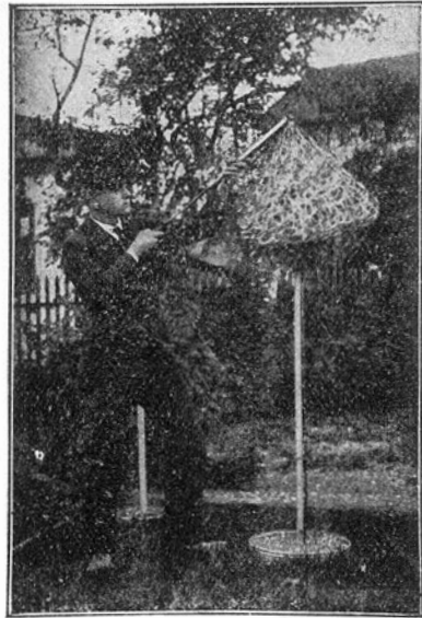
Fig. 93. Holder's Universal-Handspritze in Tätigkeit beim Bespritzen von Rosen. Mundstück kann nach allen Richtungen gestellt werden.
