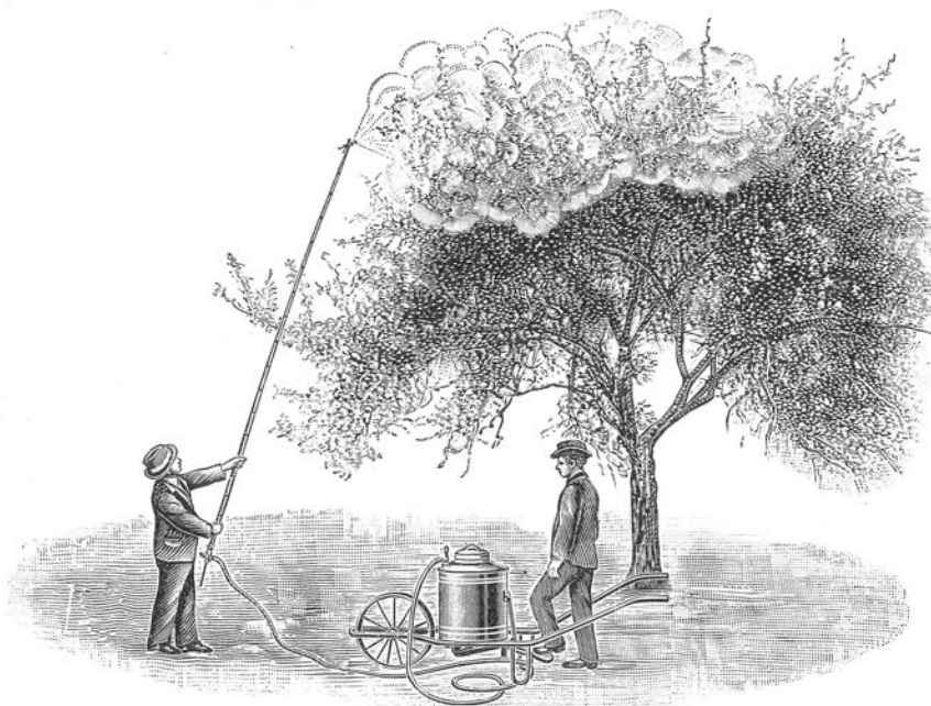
Fig. 91. Golders' fahrbare Baumspritze mit Tretvorrichtung. Für größere Anlagen geeignet. Kessel faßt 70 l Flüssigkeit. Bedienung 2 Mann.
