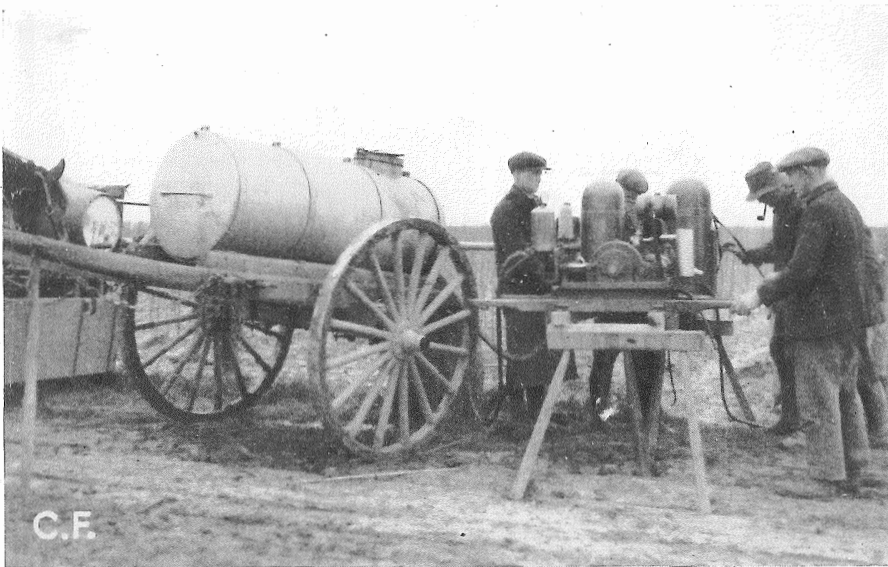
Als Rückenspritzen verwenden wir Batteriespritzen, die durch eine Motorfüllpumpe gefüllt werden.
