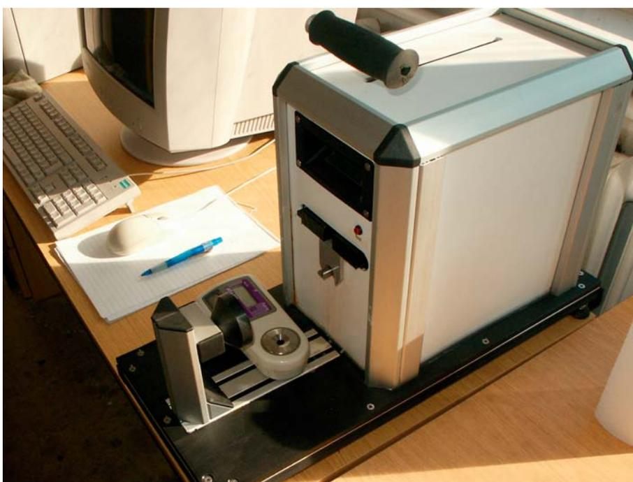
Abb. 6: ART-Reifebestimmungssystem – Penetrometer und Refraktometer in Gülzow.
