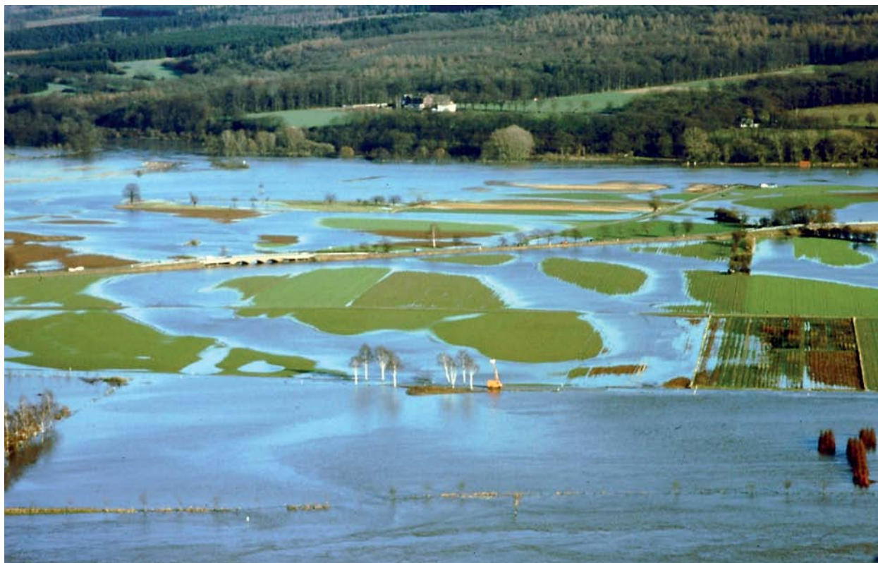
~ Die vom Fluss geformten Rinnenstrukturen in der Weseraue bei Höxter sind während eines Hochwassers noch aktiv. Dadurch sinken die Wasserstände im Fluss und der lokale Hochwasserschutz wird verbessert.
