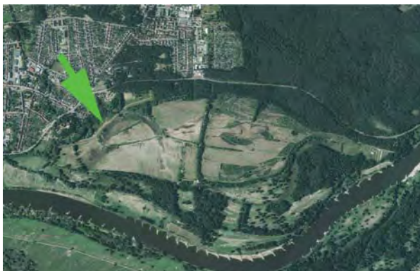
≈ Übersicht über das Projektgebiet „Roßlauer Oberluch“ an der Elbe. Das Hochwasser kann sich in diesem Abschnitt wieder bis an das natürliche Hochufer beziehungsweise bis zum neuen Deich (Pfeil), der die Ortslage schützt, ausbreiten. In der Aue hat sich eine reich strukturierte Landschaft etabliert.
